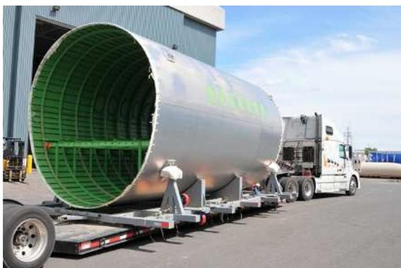
I barrel consegnati all'azienda canadese misurano 7 metri e hanno un diametro massimo di 3.7 metri. Sono composti da una lega di alluminio molto leggera e resistente.
