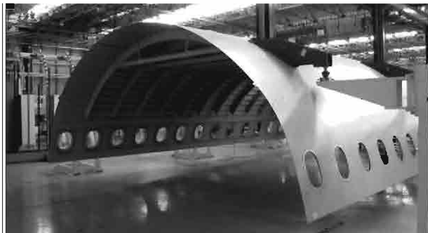
Elementi dell'A380 in costruzione all'Alenia Aeronautica di Nola
